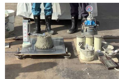
【コンクリート】フレッシュコンクリート現場試験
